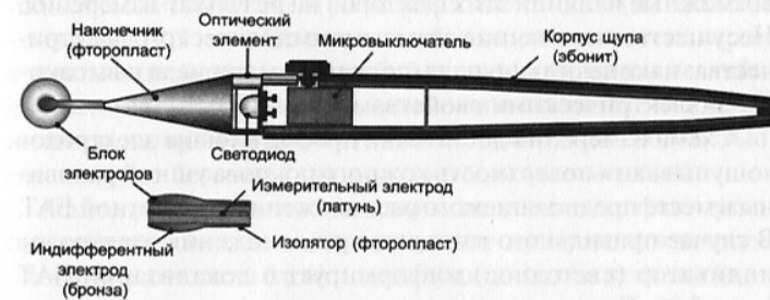
Рис. 5.2. Принципиальная схема датчика БАТ
